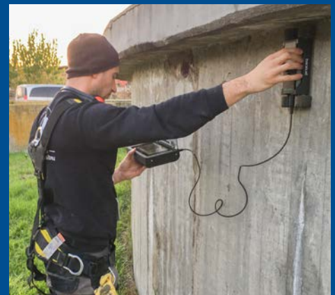
Bewehrungs-Scan zur Ermittlung der Bewehrungslagen und Betondeckung
