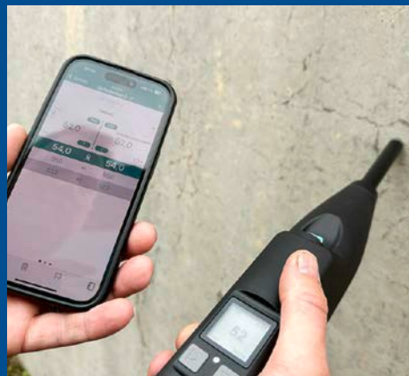
Onderzoek van de druksterkte van het beton
