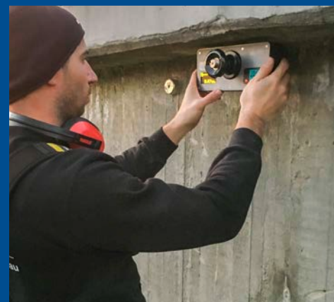
Controle van de treksterkte van het beton
