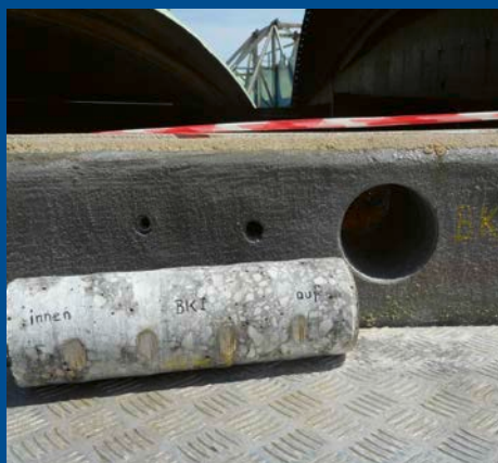
representatieve kernboringen voor externe laboratorium technische onderzoeken
